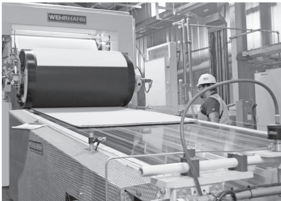
Листоформовочная машина Wehrhahn нового поколения для эффективного производства фиброцементных листов
