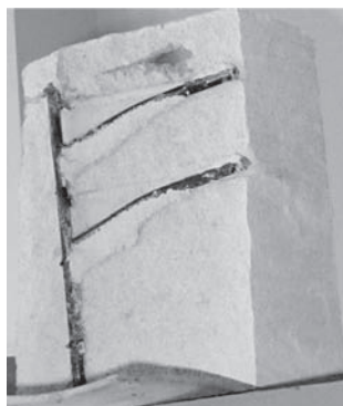
Рис. 1. Смятие ячеистого бетона под анкерами и деформирование поперечных анкеров в испытанных образцах
