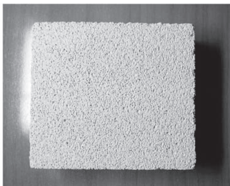
Рис. 6. Структура газобетонного блока, изготовленного на старой пасте РУСАЛ с признаками агломерации частиц алюминия (слева) и на новой продукции РУСАЛ (справа)
